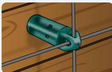
Mur de bois. Utiliser des vis de fixation adaptées.
