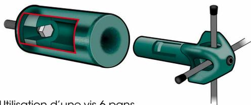
Utilisation d'une vis 6 pans M6 pour la fixation du plot sur le support (non fournie).
