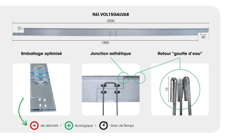
La jonction des voliges se fait en un seul point sur 2 extrémités et permet un gain de temps lors de la mise en place. L'homogénéité de la jonction est ainsi garantie ainsi que la durabilité de celle-ci sur cette zone traditionnellement plus fragile. Nous avons également optimisé l'emballage afin que celui-ci soit plus écologique, permettant ainsi un gain de temps au déballage et limitant au maximum les déchets plastiques.
